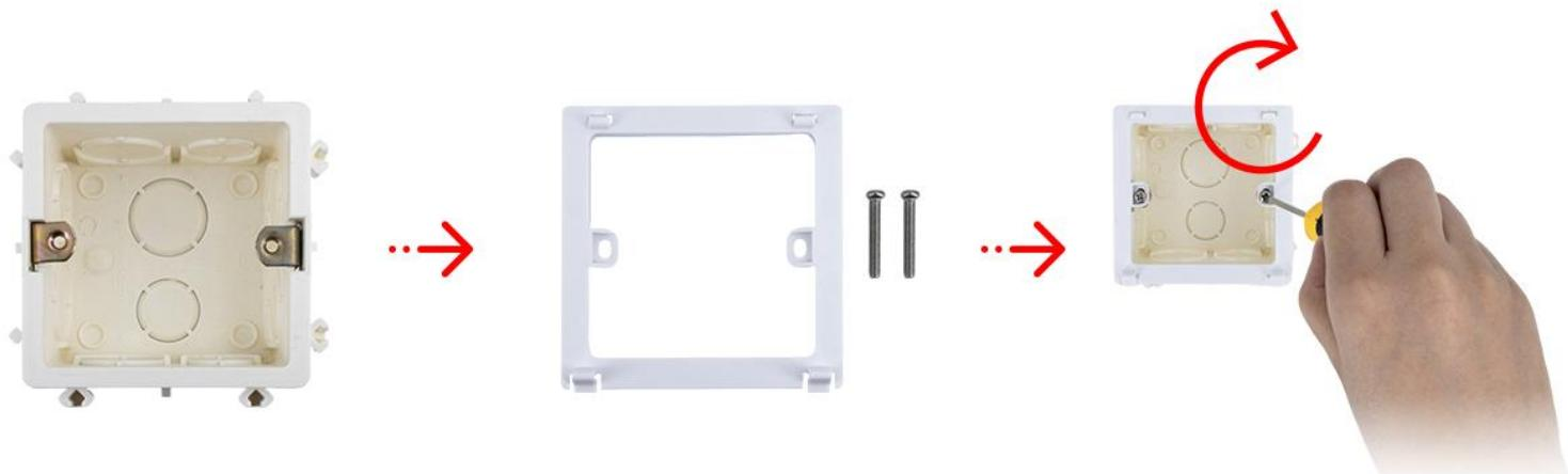
第二步：将触摸屏支架放入八六盒底座，用螺丝刀朝顺时针方向给拧紧
